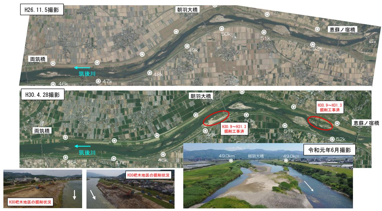
図 2.2.4-4 平成 29 年 7 月九州北部豪雨災害後の筑後川(航空写真等からみた河川の状況)
