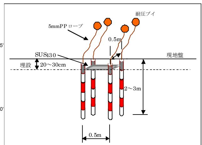
図 4.4.33 埋没測定板の装置の概要
