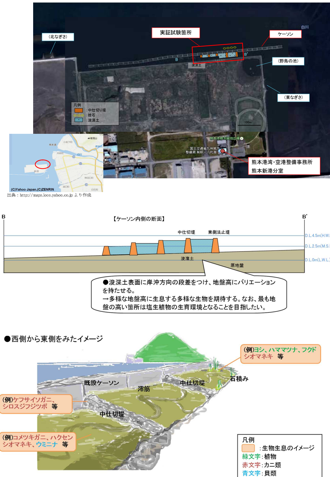
図 3.7.4 熊本港周辺での干潟・浅場の造成と造成イメージ (平成 28 年度造成)
