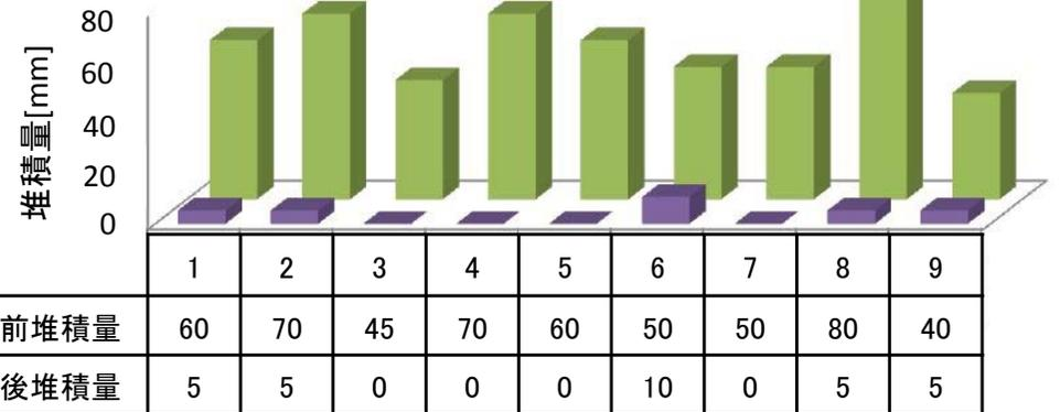
ジェットポンプを用いたメンテナンスによる浮泥の除去効果(凹凸覆砂軟型工)
