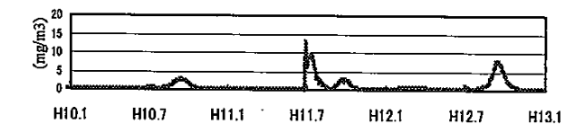
図-6 調整池からの流出 Chl-a 濃度再現結果(湾奥部)
