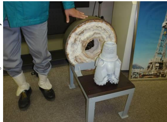
蒸気井内に付着したスケール
