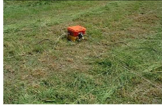
電線と受信機の設置状況
