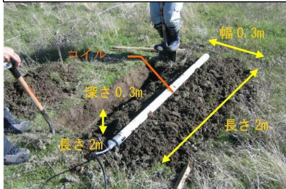
コイルの埋設状況
