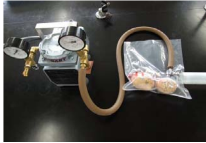
写真2. 真空ポンプによる脱気
