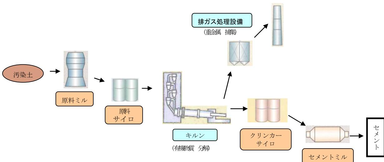
図10-2 セメント製造工程の概念図
