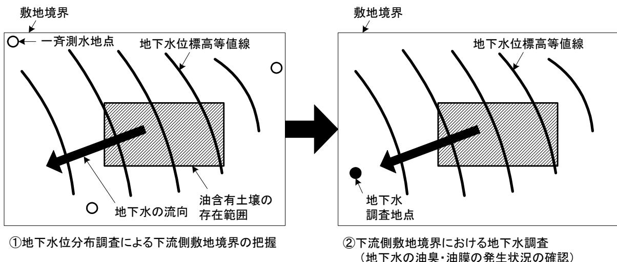
※「地下水位標高等値線」とは、地下水位の標高を求め、標高が等しい点を結んだ線を作図したものである。
