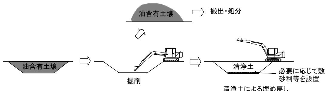
図6-1 挖削除去措置の概念図
