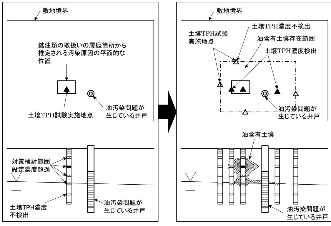
①鉱油類の取扱いの履歴から推定される汚染原因の平面的な位置での鉛直方向の油含有土壤の存在状況の把握例
