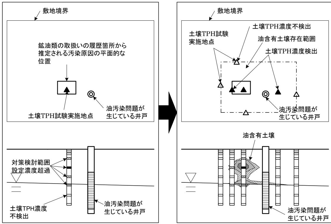
①鉛油類の取扱いの履歴から推定される汚染原因の平面的な位置での鉛直方向の油含有土壌の存在状況の把握例
