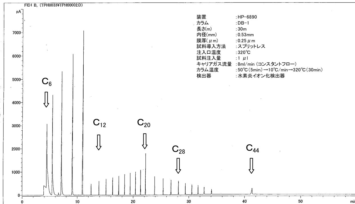
図1-2 ガスクロマトグラムの例(ノルマルパラフィンC<sub>6</sub>～C<sub>44</sub>)
