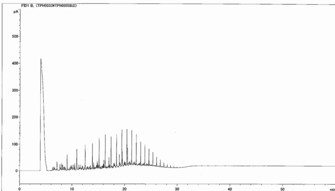
図2-1 ASTM標準軽油  $1000 \mu\text{g}/\text{ml}$  のクロマトグラム
