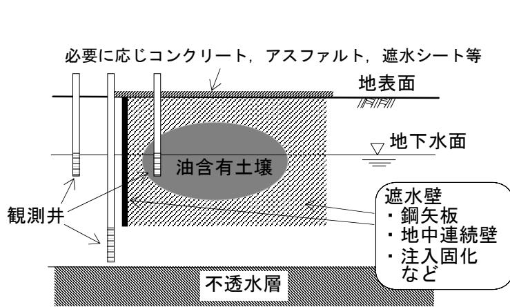
図3-1 遮水壁措置の概念図
