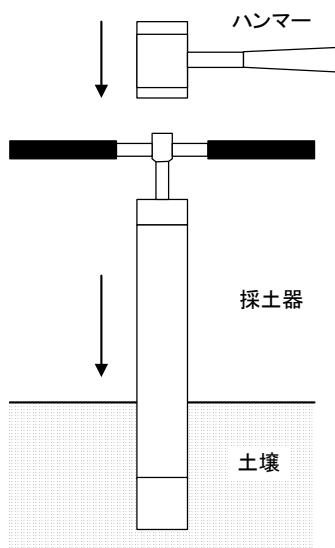
図1 採土器による土壤コア試料の採取
