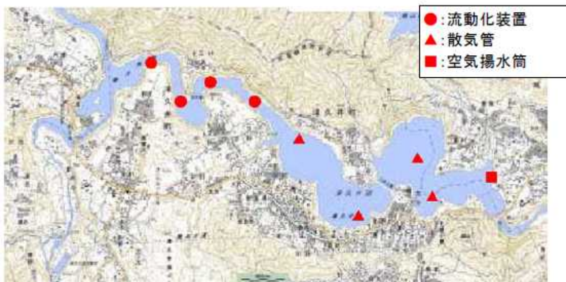
図 4.3.8 城山ダム貯水池曝気循環装置設置位置
