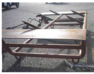
海底耕耘に用いる桁 →
