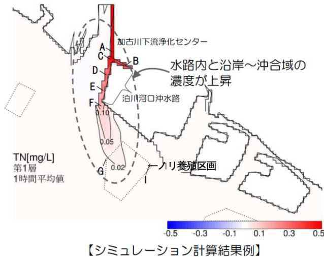
図5 窒素排出量増加運転によるノリ養殖区画への窒素供給効果
