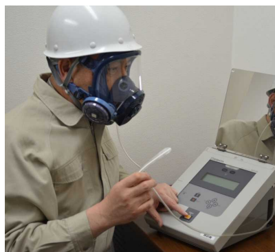
図 3.18 マスクフィッティングテスター使用例
