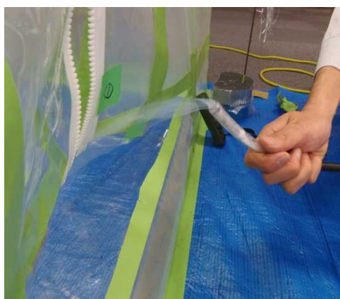
図 3.121 スモークテスターによる確認
