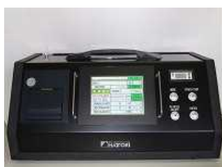
図 3. 131 繊維状粒子自動計測器の例
