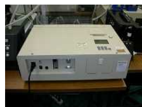
図 3. 131 繊維状粒子自動計測器の例
