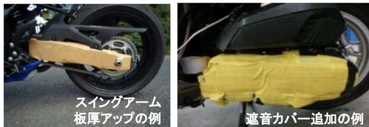
振動を軽減するための板厚アップや吸音材、遮音カバーを追加
