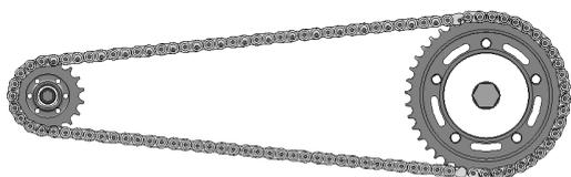
ギアの歯数の変更し、変速比を調整することにより、全開加速時のエンジン回転数(騒音値)を下げるができる。
