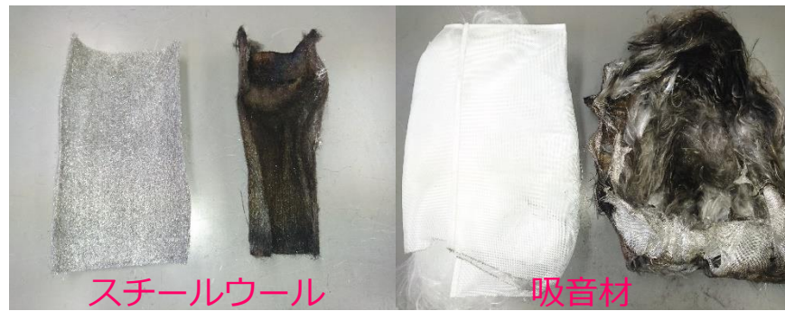
使用前後のスチールウールと吸音材の状態
