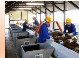
廃棄物分別作業 (環境省HPより)
