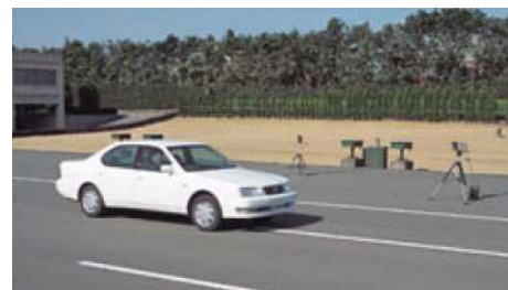
加速・定常走行騒音試験の状況 (試験コースが必要)
