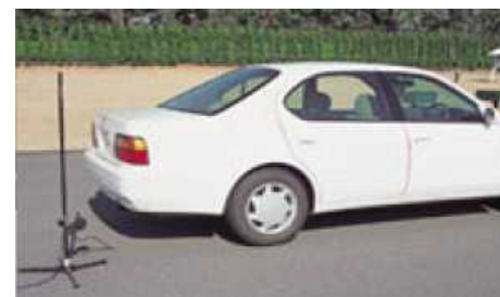
近接排気騒音の試験の状況 (試験コースは必要なし)
