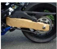
スイングアーム板厚アップの例 遮音カバー追加の例
