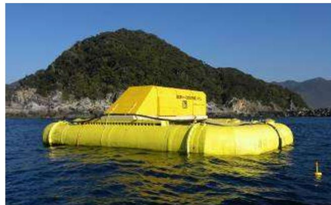
図 ジャイロ式波力発電装置
