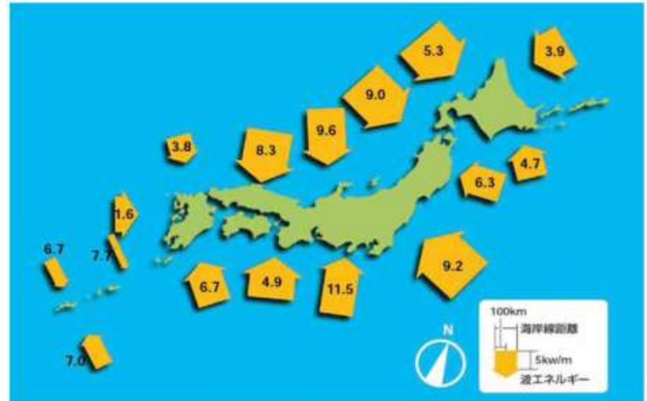
図 日本沿岸の波力エネルギー(kW/m)
