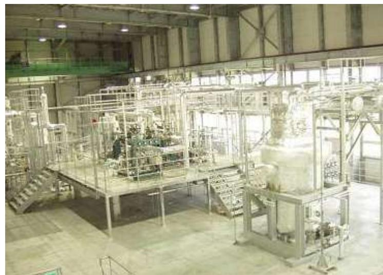
図 30kW海洋温度差発電システム
