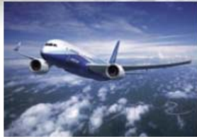
構造部材にCFRPを使用したボーイング787 写真提供：ボーイング社
