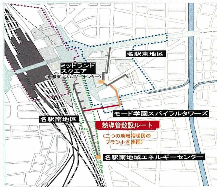
『エコまちネットワーク整備事業』にて二つの地域冷暖房地区のプラントを導管（冷水、蒸気）で接続することにより、
