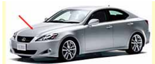
図 1. 自動車におけるアルミ製フード適用箇所
