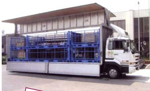
荷主別ラックの活用とトラック大型化により多数荷主の幹線輸送を共同化
