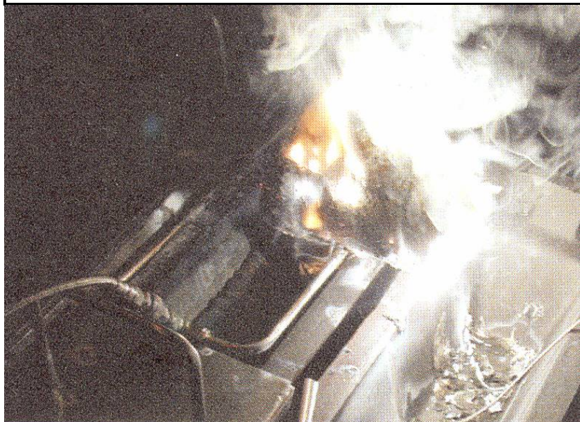
保護されていないマグネシウム溶湯 溶湯表面近傍で著しく燃焼している
