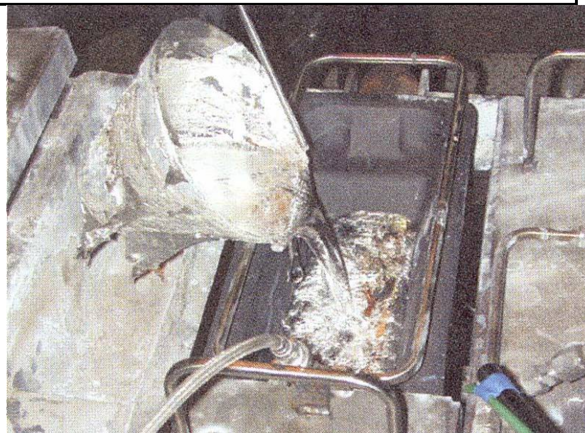
保護されているマグネシウム溶湯 溶湯表面では燃焼が認められない
