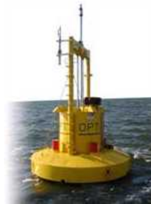
図 PB150 PowerBuoy 波力発電装置
