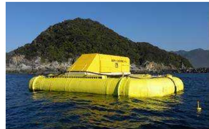
図 ジャイロ式波力発電装置 (4号機:45kW機)
