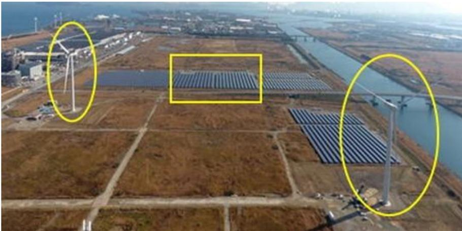
注) 太陽光 3,046kW、風力 3,300kW×2基
