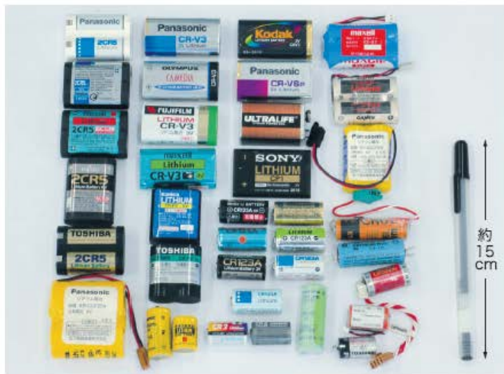
リチウム一次電池 「リチウム」や「Lithium」のみの文字表示、「CR」、「BR」、「ER」の記号があるものは対象外です。
