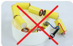
電池パックから外れかけた連結電池
