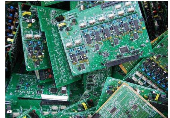
原料の例：使用済み基板類
