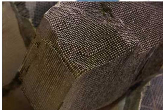
原料の例：使用済み排ガス浄化触媒
