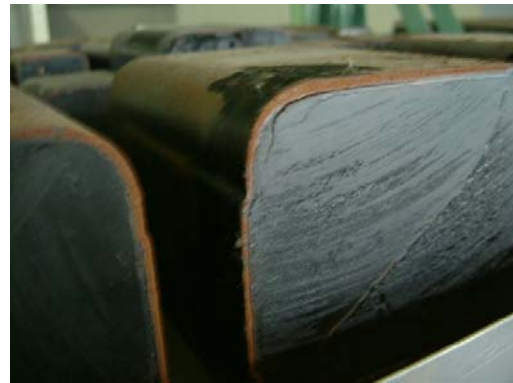
廃安定器の切断面
