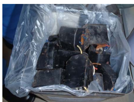
切断された廃安定器の保管例 (3)
