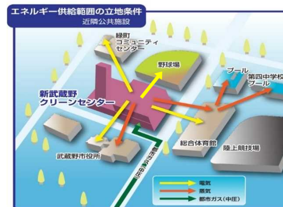
公共施設のエネルギー供給拠点
