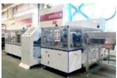
太陽光パネルリサイクル設備
