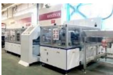
太陽光パネルリサイクル設備
