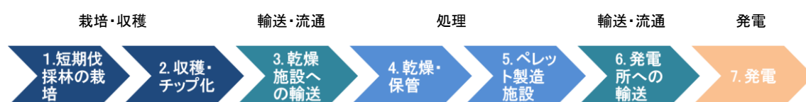
図 固形バイオマス発電のサプライチェーンの例(短期伐採林ペレット)
