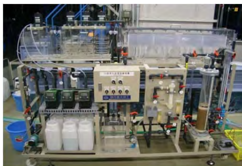
図 24 小型浄水処理実験装置の概観
