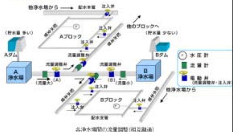
図 3-5-6 事例『漏水防止対策 (適切な配水コントロール)』(福岡市水道局)
