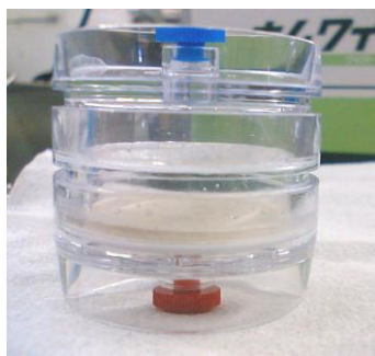
図 直径 35mm 程のプラスチック製使い捨て容器を用いて作成した酸溶解性アパタイト粒子によるケーキろ過濃縮ユニット
