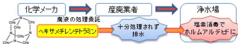
図 2 今回の事故の発生メカニズム
