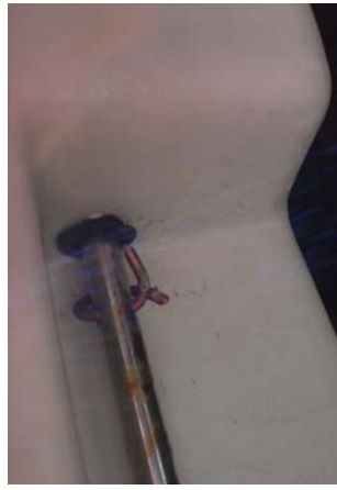
5-9改善後 蝶番軸の通し部の密閉、軸の固定
