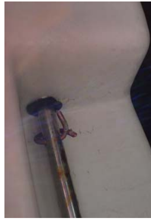
5-13改善後 蝶番軸の通し部の密閉、軸の固定
