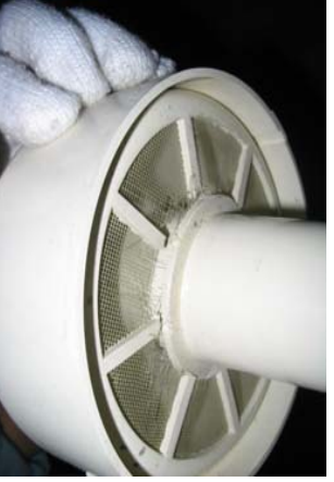
7-15改善前 防虫網の破損
