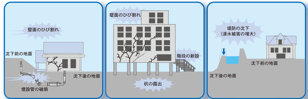
■地盤沈下による障害事例
