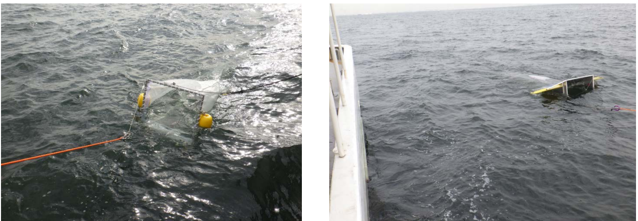
図IV-2 右舷側で曳網されるニューストーンネット（左）と左舷側で曳網されるマンタネット
