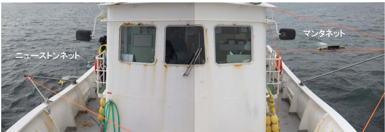
図V-1 ニューストーンネット VS マンタネット同時曳網の様子
