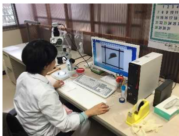
写真Ⅲ-4 画像処理ソフトを用いたサイズ測定
