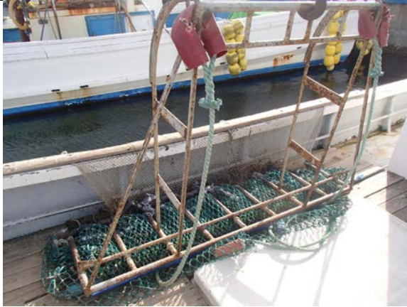
噴火湾 砂原 手操第3種 貝桁網 (1.8m×0.4m)
