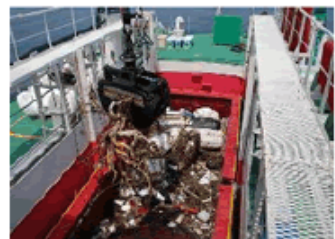
船舶搭載クレーンによるごみ回収作業
