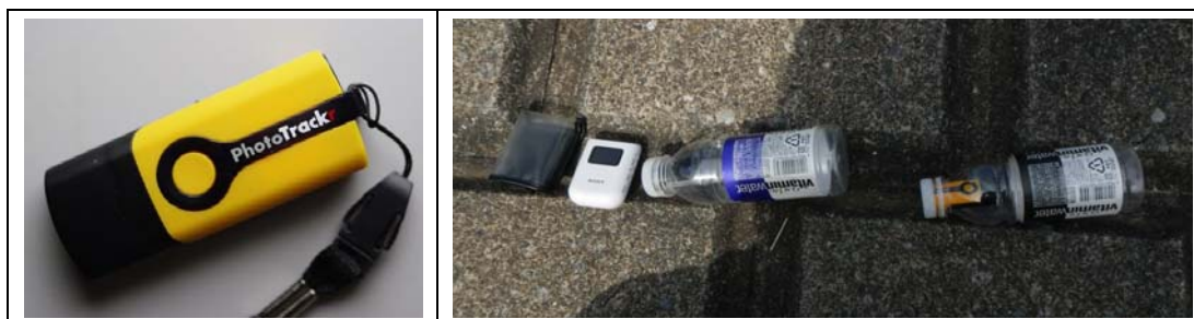
GPS ロガー（左）と広口ペットボトルにロガーを入れた状態（右）
