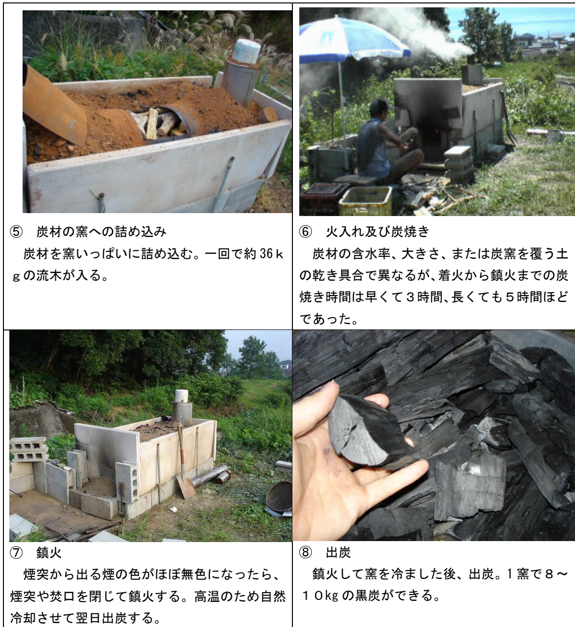
図 3.2-41 (2) 流木の炭化処理の作業の流れ
