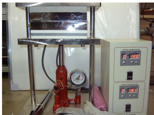
図 3.2-13 円盤状コースターを作成した熱プレス機
