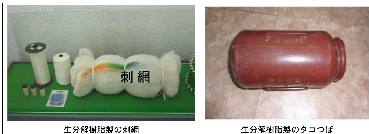
図 2.3-12 生分解樹脂製の漁具（韓国：利來化学）
