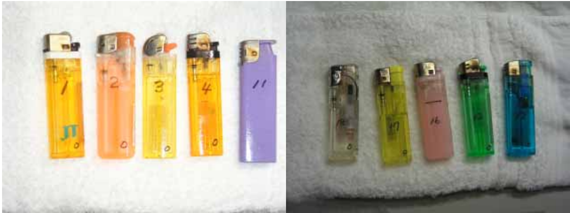
図 3.5 金属部分にサビが出始めているライター(海中設置後 3 日)
