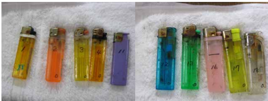
図- 2.1.9 サビが出たライター (海中設置後 13 日目)
