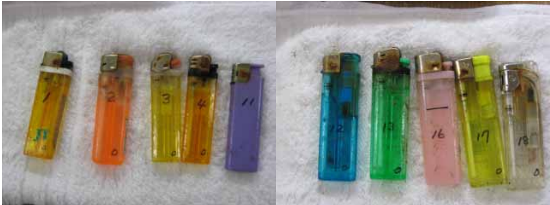
図 3.6 サビが増加したライター(海中設置後 13 日)
